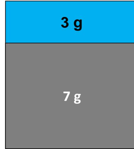
Eine feuchte Bodenprobe **10 g** = **3 g Wasser + 7 g Trockensubstanz**
