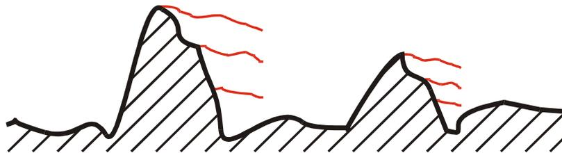
Zusätzliche Verwirbelung und Druckabsenkung hinter den Rauigkeitserhebungen.
