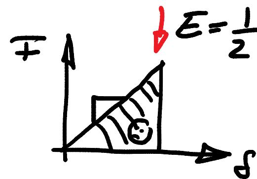
$E = \frac{1}{2} \frac{\bar{F}^2}{k}$  Verlustanzeige, da kapazitiv aufgespeist ist für eine  $\bar{k} \rightarrow \infty$
