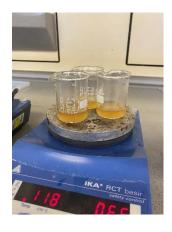
• In einem 100 mL-Becherglas wird 1,0 g Chitosan unter ständigem Rühren (Magnetrührer oder Glasstab) und leichtem Erwärmen (40 – 60 °C) in 50 mL verdünnter Essigsäure (12 %, 12 g konz. Essigsäure + 88 g Wasser) gelöst.
