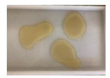
Man lässt die Produkte ca. 2 h im Trockenschrank trocknen und vergleicht anschließend ihre Konsistenz
