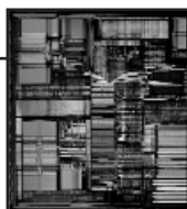
Layout-Schema des Pentium
